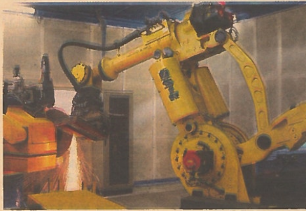
Robot antropomorfi per il settore della fonderia
